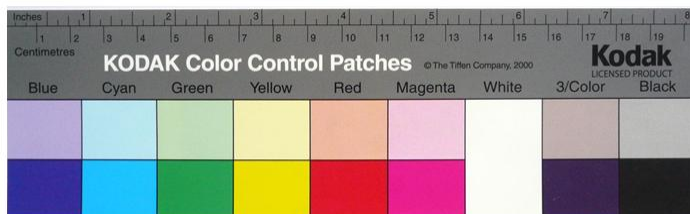
Obr. 2: Štandard Kodak Q13 s optickými denzitami (OD) 0,3 a 1,0.
